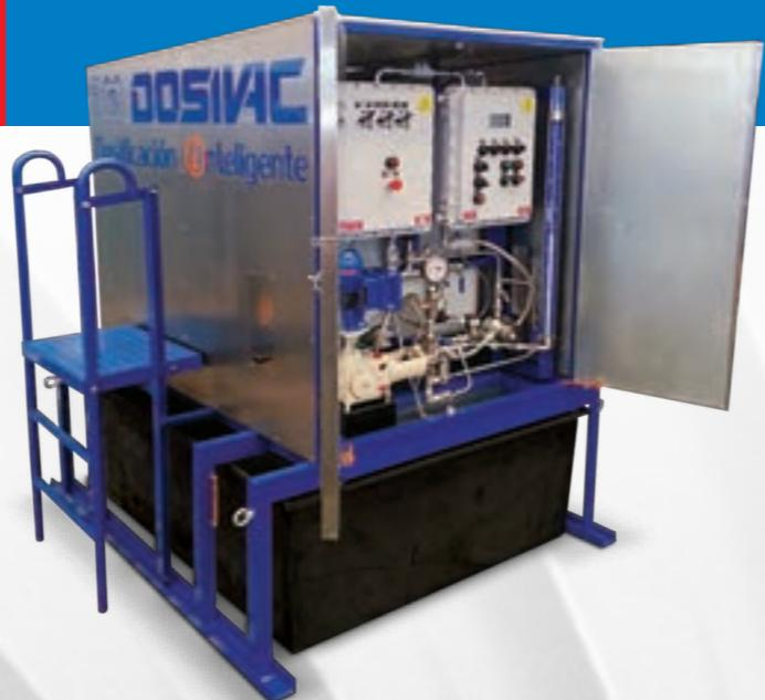
**Equipo Dosificador aislado, calefaccionado con comando y control a distancia - Para áreas peligrosas Clase 1, Zona 1 (Según IRAM-IEC-60079-10)**
